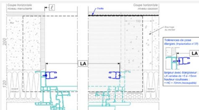
Implantation en isolation thermique par l'extérieur (ITE)
