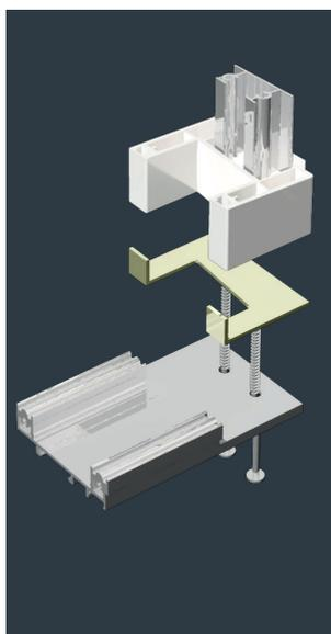
Fiabilité, simplicité et robustesse : traitée par arasement du seuil puis reprise dans le dormant par alvéo-vis rapportées, l'assemblage du seuil est durable et facilement industrialisable. La liaison robuste et le seuil filant vous permettent de manipuler vos cadres dormants ainsi équipés sans nuire à leur étanchéité.
